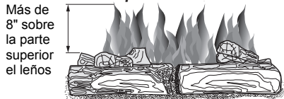
Figura 36 - Patrón incorrecto de la llama del quemador
