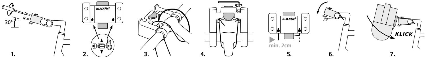
**1. Gehäuse montieren** Beide Kunststoffbügel auf den Lenker aufrasten. Das Gehäuse auf die Kunststoffbügel schieben. Schrauben in Gehäusevorderseite einstecken und leicht anspannen. Der Adapter muß dabei schräg nach oben ausgerichtet sein.
