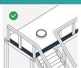
A guardrail should be placed at the edge of the duplex to ensure safe operation of the product. ガードレールを二重アパートの端に設置する必要があります。
