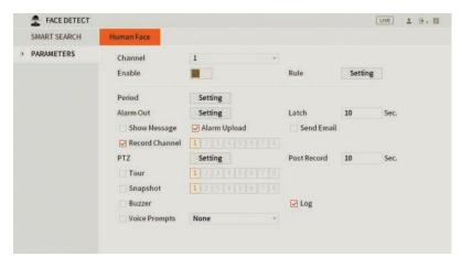
Fig. 6.1: Face Detection Parameters menu.
