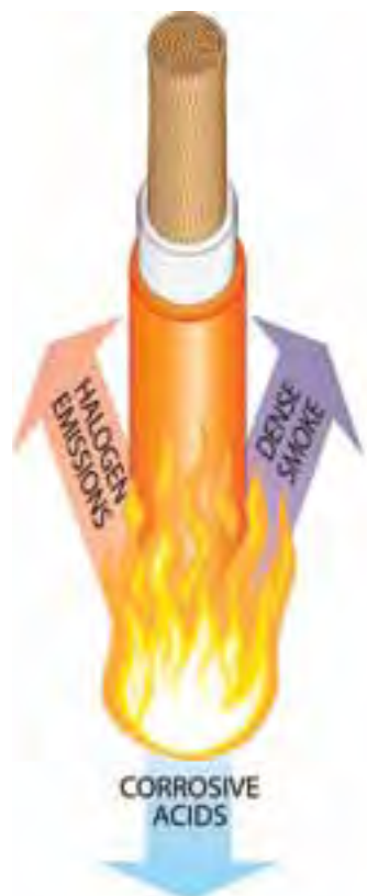
Non LSZH Cables
