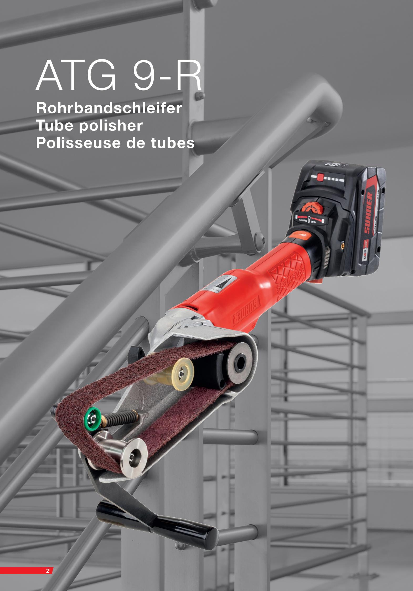
Der Akku-Rohrbandschleifer ATG 9-R von SUHNER ist bestens geeignet, um eine hohe Oberflächen-Qualität beim Schleifen und Polieren von Edelstahlrohren bis 45 mm Durchmesser zu erreichen.
