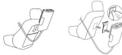
3. Para colocar el cargador trasero puedes usar el clip que se encuentra en el montaje o puedes utilizar la calcomanía para fijarlo.
