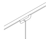
Griffausfräsung / Cut-out handles
