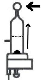
**-Una vez pinchado el barril, presionaremos el pulsador superior del Cellarbuoy hasta observar que el depósito está totalmente lleno de cerveza.**
