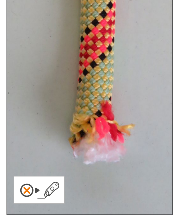
• Puna de cuerda dañada
