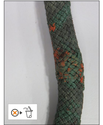
• Rastro de pintura
