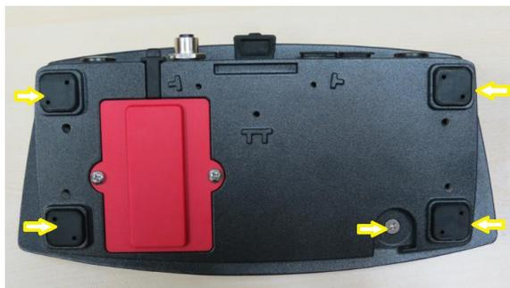
Después de quitar los tornillos que están asegurando la carcasa inferior con la cubierta superior entregar el módulo terminal. Después de eso cuidadosamente levante la cubierta superior, no retire la cubierta superior completamente de la carcasa inferior porque el Terminal teclado superposición cinta cable y el cable de cinta la pantalla TFT todavía se unen con el Terminal principal PCBA.
