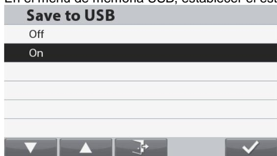
Mediante la conexión de una unidad flash USB a la escala de las lecturas de peso ahora pueden almacenarse directamente en la unidad flash USB.
