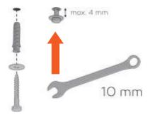
Utilice (siempre que sean aptos para el material de su pared o techo) los tacos, tornillos de llave y arandelas incluidos en el «Kit de fijación estándar» suministrado con la calefacción, tal y como se muestra en la figura de la izquierda.
