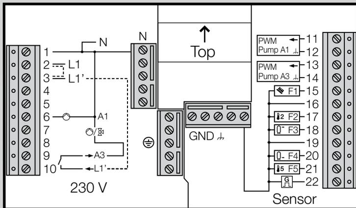
~230 V, potencia de ruptura de los relés 2(2) A, ~250 V
