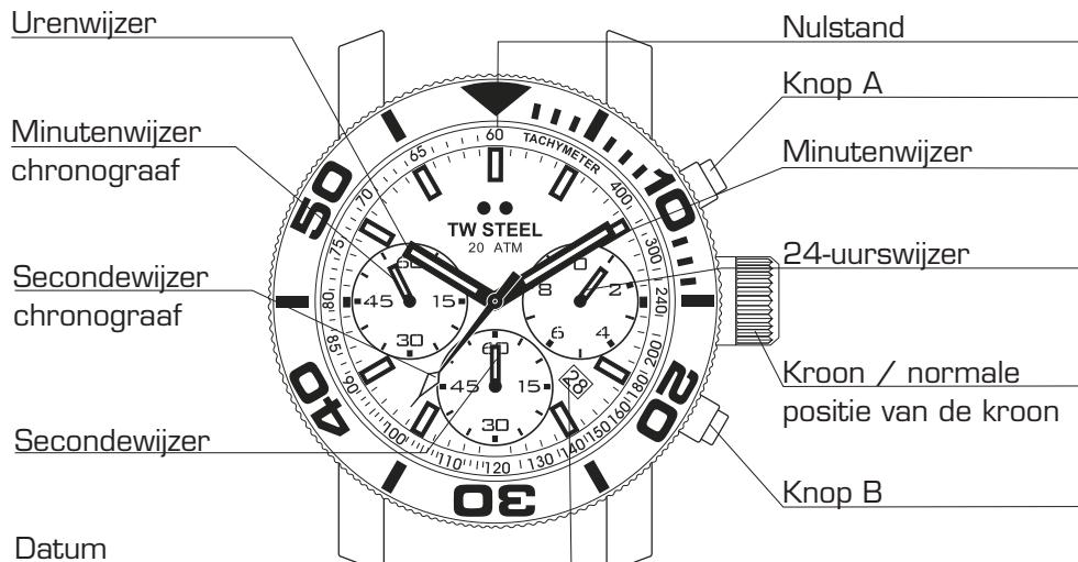
secondewijzer van de chronograaf in de nulstand te zetten. Druk op knop B om de 1/20e-secondewijzer van de chronograaf in de nulstand te zetten. De secondewijzer van de chronograaf kan snel worden rondgedraaid door knop A of B ingedrukt te houden. Zodra de wijzers naar de nulstand zijn teruggekeerd, duwt u de kroon in zijn normale stand terug en draait u de kroonkap rechtsom weer op de kast vast.
