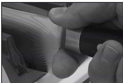
Figure 7. Placez votre index comme illustré derrière l'entablure lorsque vous insérez le couteau dans la fente à aiguiser (voir Suggestion 7).
