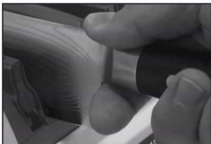
Figure 12. Placez votre index comme illustré derrière l'entablure lorsque vous insérez le couteau dans la fente à aiguiser (voir Suggestion 8.)
