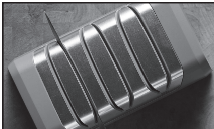
Figura 2. Inserimento della lama nell'alloggiamento destro della fase 1. Alternare singoli passaggi nell'alloggiamento destro e sinistro.
