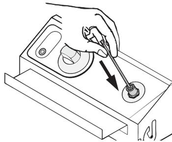
4. Vuelva a colocar la tapa del interruptor y asegúrela roscándola en sentido horario.
