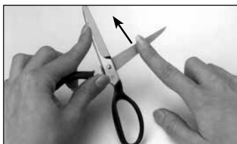
Abb. 5. Fühlen Sie vorsichtig den Schnittgrat am Blattrücken. Finger in Pfeilrichtung bewegen!
