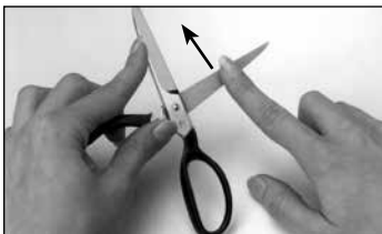
Afb. 5. Voel voorzichtig of u een braam langs de gehele snede voelt. Let op de pijlrichting.
