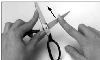
Figure 5. Contrôler avec précaution si la lame présente une barbe tout le long du dedans de la lame. Déplacez votre doigt dans le sens des flèches.
