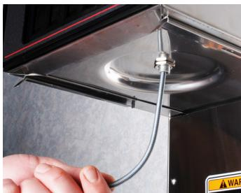
5. Con el cabezal rociador retirado, inserte un resorte de descalcificación en el tubo del mismo hasta que queden visibles aproximadamente 50 mm (2 pulgadas) del resorte. Mueva el resorte en ambos sentidos cinco o seis veces para aflojar los depósitos de calcio.
