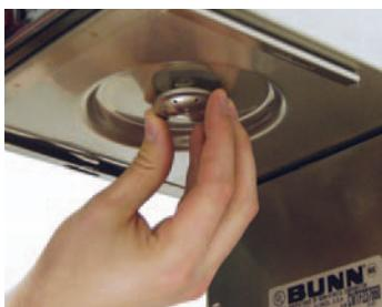
3. Retire el cabezal rociador.
