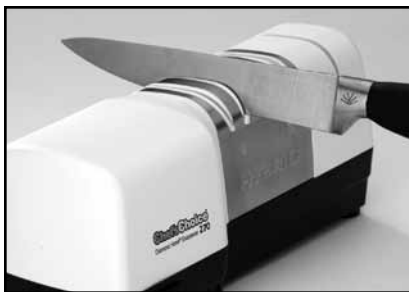
Figura 2. Inserción de la hoja en la ranura derecha de la etapa 1. Pasadas individuales alternadas en las ranura izquierda y derecha.
