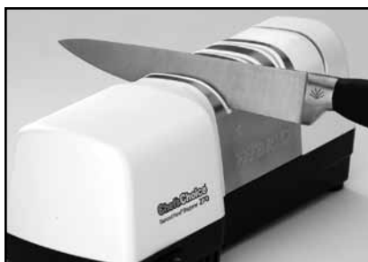
Figura 1. Inserimento della lama nell’alloggiamento sinistro della fase 1. Alternare singoli passaggi nell’alloggiamento destro e sinistro.
