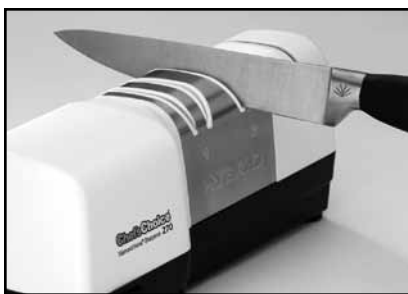
Figura 4. Inserción del cuchillo en la ranura izquierda de la etapa 2. Pasadas individuales alternadas en las ranuras izquierda y derecha.
