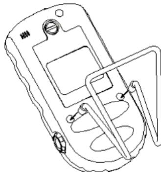
Figura 2-2 Fijar el Soporte
