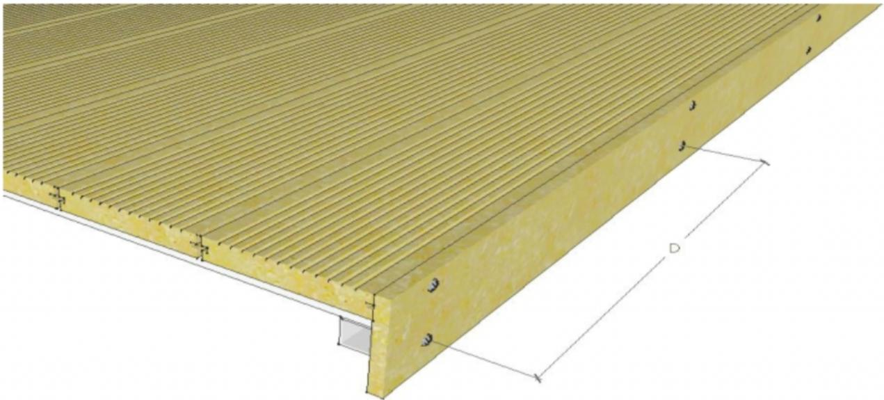
Zur Befestigung der letzten WPC/BPC Diele verwenden Sie Schrauben. Bohren sie die Dielen und auch die Unterkonstruktion unbedingt vor dem Befestigen vor. (Auch wenn sie die Edelstahlclips verwenden) Der Durchmesser der Bohrung in der Diele darf nicht kleiner als der Schraubendurchmesser sein.
