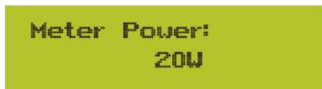
Imagen 7.5 Función de exportación cero por medio de medidor de energía encendido
