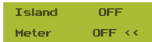
Imagen 7.4 Interruptor de medidor
