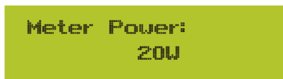
Imagen 7.5 Función de cero exportación por medio de medidor de energía encendido
