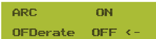
Imagen 8.30.2 Detección de fallos de arco.
