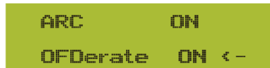
Imagen 8.30.2 Detección de fallos de arco.
