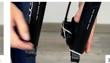
**IMPORTANT POUR UN RÉSULTAT OPTIMAL :** Contrôlez à nouveau que les pistons se trouvent bien en position finale. S'il s'avère impossible de mettre les pistons dans cette position, vous devez d'abord ouvrir le système au niveau du réservoir de compensation. (voir étape 7)
