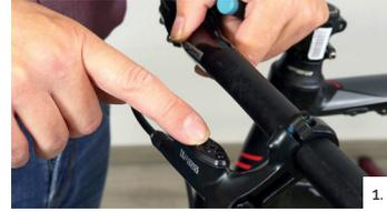
Retirez la vis de purge du réservoir de compensation au niveau de la poignée de frein à l'aide de la clé Torx (8) ou d'une clé Allen. Sélectionnez l'adaptateur correspondant au frein et vissez-le. (Comparez vis et adaptateur comme indiqué dans la vidéo).
