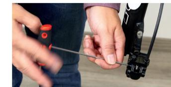
La goupille doit être redressée à l'aide d'une pince plate puis extraite (la goupille peut être réutilisée pour autant qu'elle n'a pas été endommagée).
