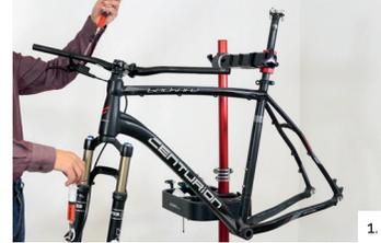
**ASTUCE :** Pour un résultat de purge optimal, actionnez et relâchez rapidement le levier de frein de temps en temps, afin d'évacuer les bulles d'air présentes au niveau de la manette. Vous pouvez aussi tapoter doucement la durite de frein et l'étrier, p. ex. à l'aide de la partie caoutchoutée d'un manche de tournevis.
