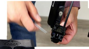
Pour éviter tout risque d'endommagement, n'utilisez aucun objet métallique/pointu, tel que couteau ou tournevis. Enfoncez le cale-pistons dans
