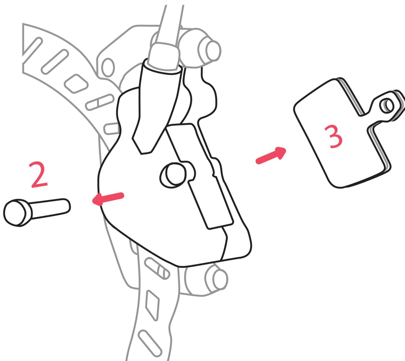
Consejo: comprobar que las pastillas de freno tienen un desgaste uniforme. De lo contrario, esto puede indicar un pistón atascado o una pinza torcida.
