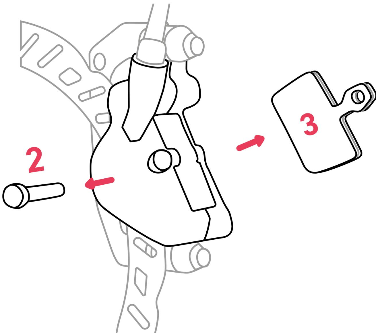
**Tipp:** Kontrollieren, ob die Bremsbeläge gleichmäßig abgefahren sind. Andernfalls kann das auf einen feststehenden Kolben oder schiefen Bremssattel hindeuten.
