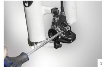
**3. Die Kolben im Bremssattel** müssen jetzt komplett nach hinten gedrückt werden. Hierfür kann der mitgelieferte **Bleed block (4)**, oder ein Stück Holz/ Kunststoff verwendet werden.
