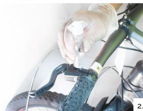
**WICHTIG:** Der mitgelieferte **M6 Stutzen Adapter (3)** passt nicht in die Öffnung der EBT Verschraubung. Spritze ohne Adapter (3) und ohne Schlauch einstecken. **Einschrauben des Stutzens kann zur Beschädigung des Gewindegangs führen.**
