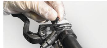
**TIPP:** Vor dem verschließen darauf achten, dass Mineralöl bis zum Rand der EBT Öffnung ansteht. Sollte hier etwas Mineralöl fehlen, muss unten an der Spritze noch minimal gedrückt werden, so dass das Mineralöl bis zum Rand steht und keine Luft in das System kommt.
