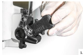
**WICHTIG FÜR EIN OPTIMALES ERGEBNIS:** Kontrolliere nochmals, ob die Kolben in der Endposition sind. Sollten die Kolben sich nicht in die Endposition bringen lassen, muss zuerst das System am Ausgleichsbehälter/EBT Schraube geöffnet werden. (Siehe Schritt 7)
