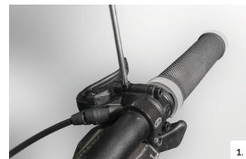
Jetzt die Spritze ohne Kolben und Ohne M6 Stutzen Adapter (3) in die Öffnung stecken. Durch die konische Form der Spritze, kann diese fest und luftdicht einfach in die EBT Öffnung aufgesteckt werden.
