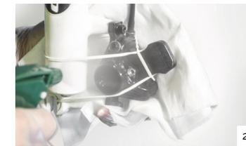
**13** Nochmals prüfen, ob der Druckpunkt jetzt straff und definiert ist. Dann Bleed block entfernen und Bremsbeläge einsetzen. Anschließend Laufrad einsetzen und Bremshebel wieder in die gewünschte Position drehen. Erneute Funktionsprüfung.
