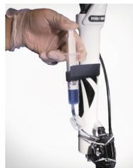
**8-A** Klemme am Schlauch öffnen und den **Kolben an der Entlüftungsspritze am Bremssattel** langsam drücken. Der Spritzenkörper am Bremsgriff wird sich nun mit Mineralöl füllen. Du siehst nun auch im Spritzenkörper am Bremsgriff kleine **Luftblasen** aufsteigen.
