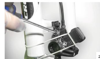
**9-B** Mit der Spritze am Bremssattel so viel Öl in das Ölbad des Ausgleichbehälters drücken, bis das Öl am oberen Rand ansteht. Anschließend die Gummilippe (Balg) auflegen. Jetzt wird ein wenig Öl überlaufen. Diese mit einem Tuch auffangen.
