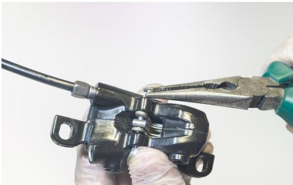
3. Los pistones de la pinza de freno deben **ahora ser empujados completamente hacia atrás.** Utilice el bloque de sangrado (6) o un trozo de madera proporcionado para este fin.
