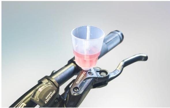
**11. Después de 2 o 3 veces de "bombear"** la palanca de freno, deberías tener de nuevo un punto de presión óptimo. Entonces puedes cerrar el embudo con el tapón del embudo y desenroscarlo con cuidado.
