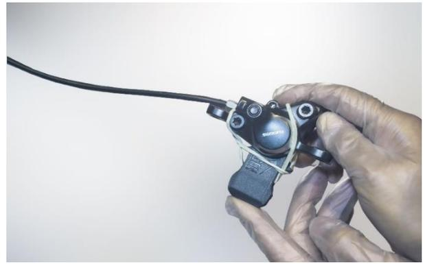
**Importante para un resultado óptimo:** Compruebe de nuevo que los pistones están en la posición final. Si no se puede llevar los pistones a la posición final, primero hay que abrir el sistema del depósito de expansión. (Véase el paso 7)
