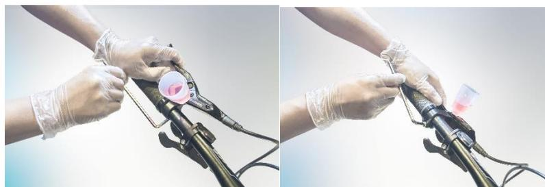
**10. Cierra el tornillo de ventilación tan pronto como no suban más burbujas de aire en el embudo o la jeringa.** Para ello, cierre el tornillo de ventilación de la pinza de freno. (Atención: Observe el par de apriete correcto - valor guía: 4-6 Nm)
