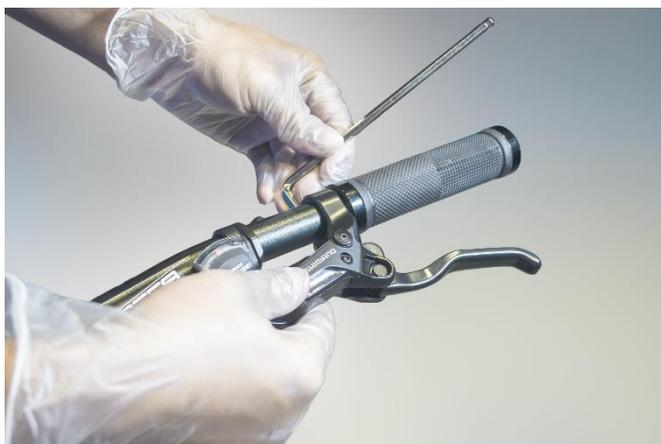
2. Quita las pastillas de freno para evitar la contaminación. **Bajo ninguna circunstancia debe entrar aceite en las pastillas de freno o en el disco de freno.** Las pastillas de freno suelen estar aseguradas con una clavija partida o un tornillo de retención de pastillas. El tornillo de retención de las pastillas se puede desenroscar fácilmente.
