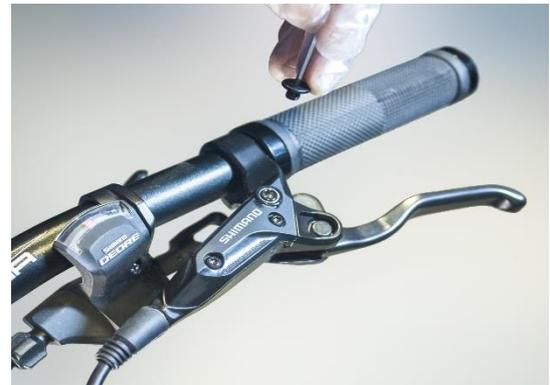
**Ahora desenrosque el embudo** (no inserte el tapón del embudo en el embudo). Es suficiente con apretarlo ligeramente con la mano. A continuación, llene el embudo de aprox. 1 cm de altura con aceite mineral del frasco dosificador.
