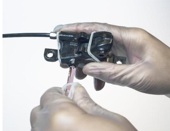
Para evitar que la manguera vuelva a deslizarse del pezón durante el proceso de sangrado, fije la jeringa al marco o a la horquilla con la cinta de **velcro** (8) incluida en el volumen de suministro. El pistón de la punta para tirar debe apuntar hacia arriba.
