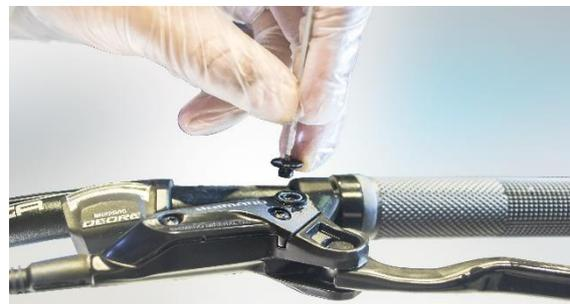
Esto hará que salga un poco de aceite mineral al atornillar. Al atornillar, preste especial atención al par de apriete del fabricante (véase el manual de frenos) - valor orientativo: 0,3-0,5 Nm.
