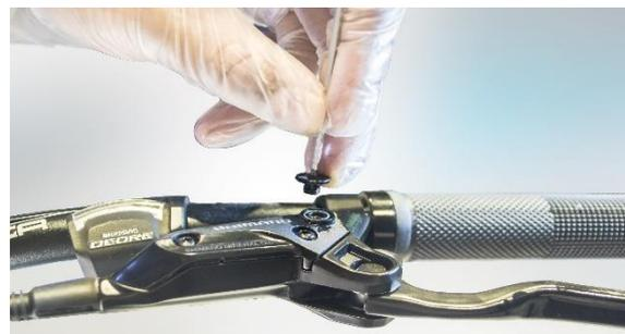
**Suggerimento:** per evitare di stringere troppo la vite senza chiave dinamometrica, bloccare l'esagono incassato solo con 2 dita (pollice e indice) e stringere la vite con molta attenzione.
