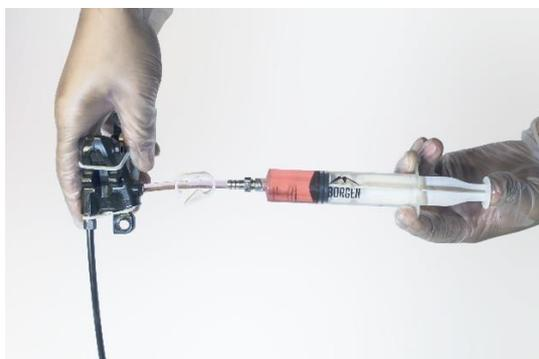
**7. Rimuovere la vite di spurgo sul serbatoio della leva del freno.**
