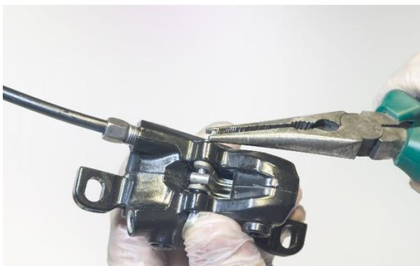
**3. I pistoni della pinza del freno devono ora essere completamente spinti indietro. A tale scopo utilizzare il blocco di spurgo (6) o un pezzo di legno fornito in dotazione.**
