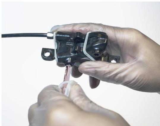
Per evitare che il tubo flessibile scivoli di nuovo via dal capezzolo durante il processo di spurgo, fissare la siringa al telaio o alla forcella con il nastro in velcro (8) incluso nella fornitura. Il pistone del puntale per il tiro deve essere rivolto verso l'alto.
