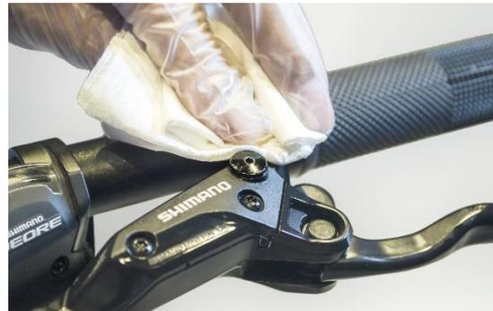
**13. Verificare nuovamente** se il punto di pressione è ora stretto e definito. Quindi rimuovere il blocco di spurgo e inserire i pattini dei freni. Inserire quindi la ruota e girare la leva del freno nella posizione desiderata. Controllare di nuovo il funzionamento.
