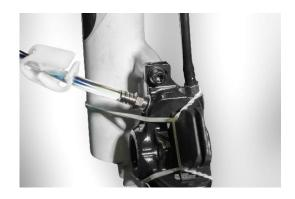
Para asegurarse de que el tubo no resbale durante el proceso de ventilación, asegure las jeringas con el velcro incluido en el marco de la bicicleta. El pistón de la jeringa para tirar debe estar hacia arriba.
