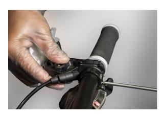
Las pastillas de freno suelen estar aseguradas con un tornillo de retención de pastillas. El tornillo de sujeción de las pastillas se puede desatornillar fácilmente (véase 3.).
