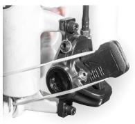
MPORTANTE PARA UN RESULTADO ÓPTIMO: Compruebe de nuevo si los Pistones están en la posición final correcta. Si los pistones no pueden ser puestos en la posición final correcta, el sistema debe ser abierto en el depósito / tornillo EBT. (Ver paso 7)
