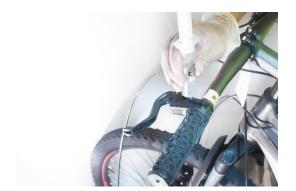
IMPORTANTE: El adaptador de boquilla M6 incluido no encaja en la abertura de la conexión de tornillo EBT. Inserte la jeringa sin el adaptador o el tubo. ¡Enroscar la pieza de conexión podría causar daños en la rosca!
