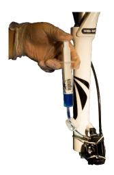
**8-A** Abre la pinza del tubo y presiona lentamente el pistón de la jeringa de sangrado de la pinza de freno. El cuerpo de la jeringa en la pinza de freno se llenará ahora con aceite mineral. Ahora puedes ver que pequeñas burbujas de aire suben dentro del cuerpo de la jeringa en la manija del freno.
