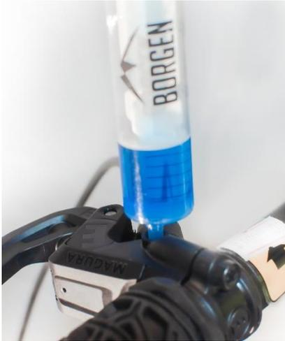
**CONSIGLIO:** Se nell'olio sono presenti corpi estranei come trucioli metallici o particelle di sporco o se il colore non è blu, smaltire correttamente il vecchio olio minerale e pulire la siringa. Riempire quindi il corpo della siringa pulito con olio minerale e rimetterlo nell'apertura EBT. A questo scopo si può attaccare il tubo flessibile e rimontare lo stantuffo della siringa.
