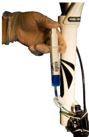
**8-A** Aprire la pinza sul tubo e premere lentamente il pistone sulla siringa di spurgo della pinza del freno. Il corpo della siringa sull'impugnatura del freno si riempirà ora di olio minerale. Ora si può vedere che all'interno del corpo della siringa si formano piccole bolle d'aria all'interno del corpo della siringa sull'impugnatura del freno.
