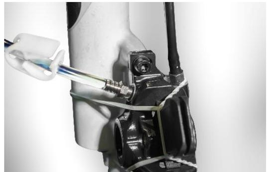
Per assicurarsi che il tubo non scivoli durante il processo di ventilazione, fissare le siringhe con il velcro in dotazione al telaio della bicicletta. Lo stantuffo della siringa per la trazione deve essere rivolto verso l'alto.
