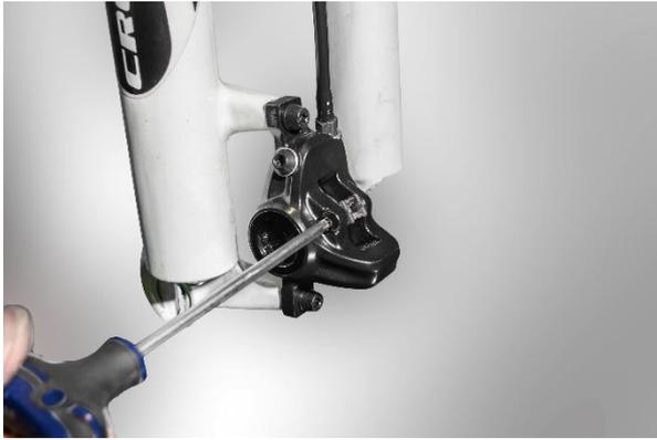
**3. I pistoni della pinza del freno devono ora essere spinti completamente all'indietro.** A tale scopo si può utilizzare il blocco Bleed fornito in dotazione, oppure un pezzo di legno/plastica.
