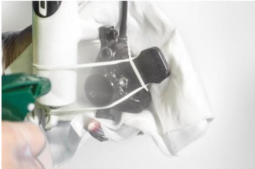
con l'olio con alcol isopropilico o alcool. (Fare attenzione al contatto con la vernice, ad esempio con le parti del telaio)
