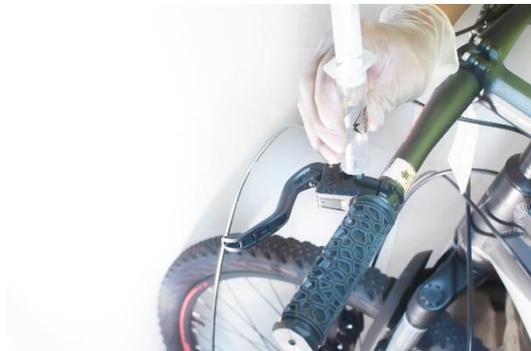
**! IMPORTANTE !:** L'adattatore per ugelli M6 in dotazione non si adatta all'apertura del collegamento a vite EBT. Inserire la siringa senza adattatore o tubo.
