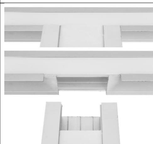
Para evitar sombras en una intersección de dos perfiles de aluminio, puede hacer un saque en la pared interior del perfil y colocar la tira de LED continua. Siempre haga que las micas de los dos perfiles queden perfectamente unidas para que no haya puntos de sombra y/o fugas de luz. Si es necesario aplique silicón semitransparente en las uniones de las micas para asegurar que no haya fugas de luz.
