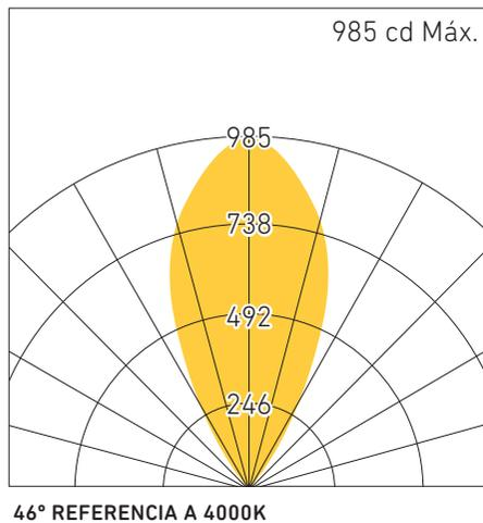
5.1 EFICIENCIA DEL SISTEMA: 69 lm/W @ 2700 K
