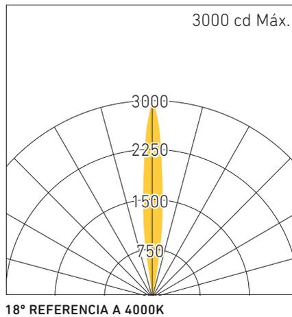
5.1 EFICIENCIA DEL SISTEMA: 78 lm/W @ 2700 K
