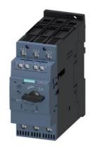
Interruptor automático tamaño S2 para protección de motores, CLASE 10 Disparador por sobrecarga con retardo según intensidad 42...52 A Disparador de cortocircuito 741 A borne de tornillo poder de corte estándar con bloque de contactos auxiliares transversal 1 NA+1 NC
