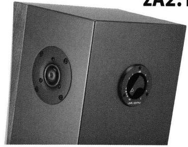
エンクロージャのサイドパネル上方には、同社がairLayer(エアレイヤー)と呼ぶアンビエンス調整用トゥイターを装備(片側のみ)。同トゥイターは2kHz~6kHzの帯域に働きかけ、空間の広がり方やスイスポット以外でのリスニングに対して特に効果を発揮するという。エンクロージャのリアパッフル上方に備わるツマミでレベル調整が可能。
