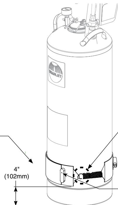
B Use alicates o una herramienta similar para fijar la correa del calentador al tanque.
