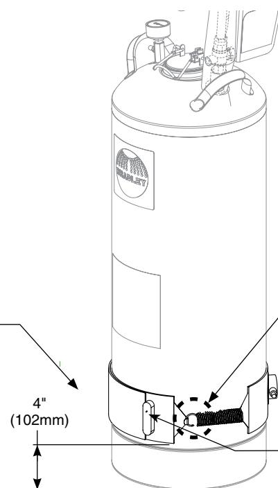
**B** Avec une pince ou autre outil semblable, attacher la bande chauffante au réservoir.
