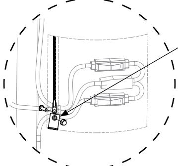
**A** Alinee la cavidad en el camisa calentadora, directamente al lado del yugo del lavajos, lejos del resorte de retención en la base del calentador. Deslice el camisa calentadora hacia fuera del tanque.
