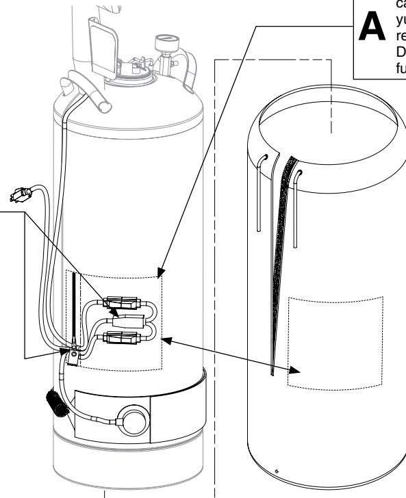
**D** Enrute el cable eléctrico fuera de la parte inferior de la ranura de gancho y bucle en el camisa calentadora. Fije las regletas de gancho y bucle en la ranura del camisa calentadora. Tire firmemente del cordón en la parte superior del camisa calentadora.
