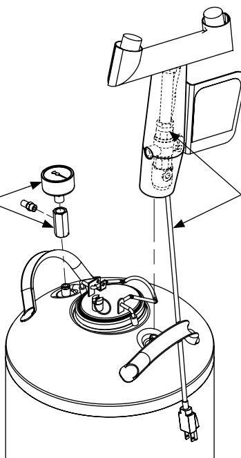
**A** Monter la douche oculaire sur l'orifice de sortie du réservoir. Couple maximum 150 in-lbs. Passez le câble dans la manette du réservoir.
