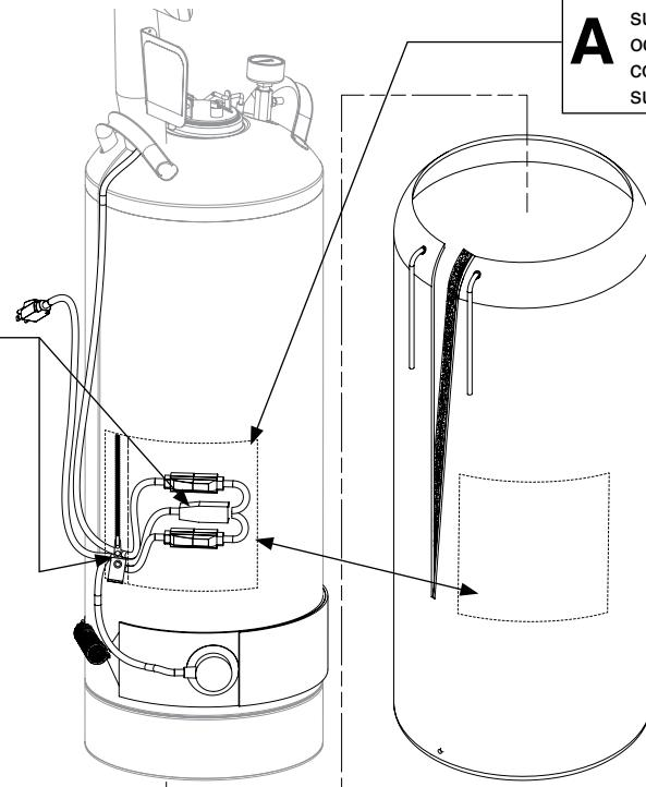
**A** Placer la poche de la chemise juste sur le côté de la tête de douche oculaire, à l'écart du ressort du coussin chauffant. Enfiler la chemise sur l'extérieur du réservoir.
