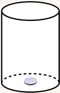
Sobald der Magnet zu tanzen beginnt, können Sie davon ausgehen, dass die Magnetfeldspulen ordnungsgemäß funktionieren.
