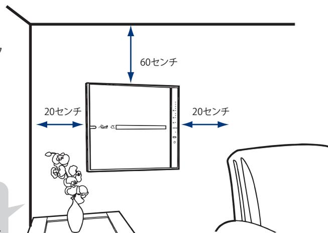
確実に部屋の空気を清浄するために、空気清浄機を上方60cm・左右20cm、壁や物から離して設置してください。
