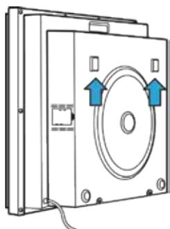
7. 金具が壁に確実に固定されたのを確認して、本体を上からゆっくりとスライドさせながらフックにかけてください。本体は前面に傾けず、上から垂直にかけてください。
