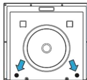
4. 空気清浄機を壁に水平に設置するため、金具のくぼみに水平器を入れてください。
