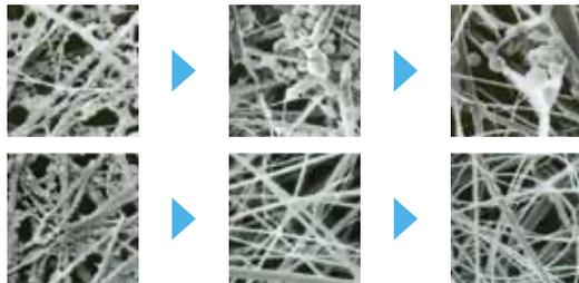
BioGS™ HEPAフィルターでは、捕集されたアレルギー\*2や細菌\*3が時間の経過と共に減少していきます。
