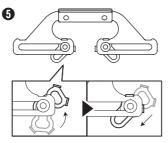
ロックピースをセットし、上図の状態にします。両ハンドルのロックピース、計4ヶがセットされている事を必ず確認してください。
