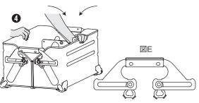
本体の両端(ボックス)を手で持ち、スライドピンが図Eの状態になるまで、本体を閉じます。
