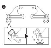
4ヶ所のロックピースを解除し、ハンドルを上図の状態にします。ロックピースがしっかりと下がっていない場合、本体の開閉時に部品が干渉しますので、注意してください。
