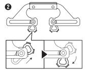
4ヶ所のロックピースを解除し、ハンドルを上図の状態にします。ロックピースがしっかりと下がっていない場合、本体の開閉時に部品が干渉しますので、注意してください。
