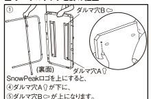
天板の表を手前にして体の前に置き、脚を持ちます。 天板裏の下部にある2つの④ダルマ 次に脚の曲がり部分を持ち、ジョイントピン 3ヶ所のジョイントピンが確実に挿入された事 この時スノーピークロゴを上にします(逆向きでは組み 立てられません)
