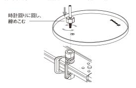
③固定用シャフトネジ部を最後まで締め込んだ後、任意の位置にトレーを合わせてます。 位置を合わせたら固定用ナットをトレーが動かなくなるまで時計回りにねじ込み、最後まで 締め込んでください。
