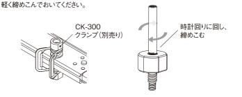
②トレーの穴と CK-300 クランプのネジ穴を合わせ、CK-300 クランプのネジ穴に①で作った ナット付き固定用シャフトを時計回りにねじ込み、最後まで締め込んでください。
