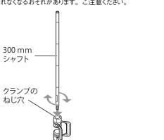
②もう片方の CK-300 クランプを、左右に動かせる程度の締めこみでテーブルに仮固定 します。
