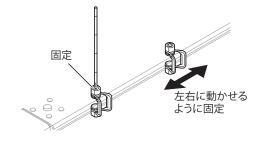
③②で仮固定した CK-300 クランプに、①と同様に、 時計回りに 300 mm シャフトを締 めこみ固定します。
