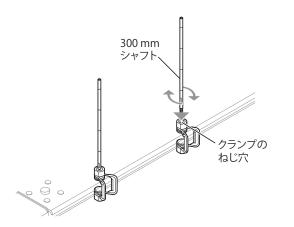
④コの字金具のジョイントボルトを 300 mm シャフトのねじ穴にはめ込み、時計回りに回 転させて、左右順番に締めこみます。ジョイントボルトのねじ穴の位置が合わない場合、 ②で仮固定した CK-300 クランプの位置を左右に調整し、コの字金具の左右両方の ジョイントに緩みがなくなるまで締めこんでください。
