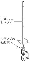
②300 mm シャフトに緩みがないことを確認し、300 mm シャフトのねじ穴にクランクシャフトねじ部を時計回りに回して締めこみます。このとき、ローレットナットがねじ部の根元の位置に来るまで、軽く締めこんでおいてください。また、危険ですのでクランクシャフトを回すときはランタンハンガーを広げないでください。
