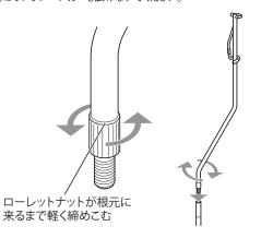
③クランクシャフトねじ部を最後まで締めこんだ後、クランクシャフトを逆に回し、ランタン ハンガーの方向を決めます。ランタンハンガーの方向を決めたら、ローレットナットを時 計回りに回転させ、ねじが止まるまで締めこんでください。
