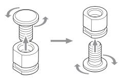
●取り外しと逆の手順でアームにボルト / ナットを装着します。
