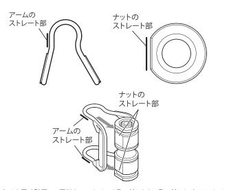
●ボルトを反時計回りに回転させ、ナットから取り外します。取り外したボルトはナットの 反対側に装着してください。
