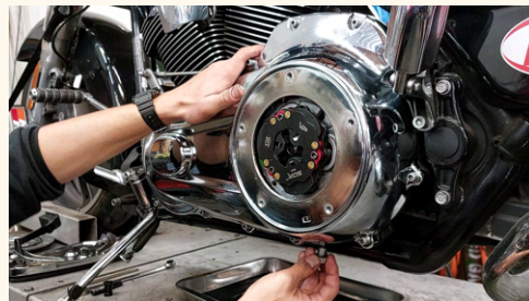
28. Return drain bolt.
