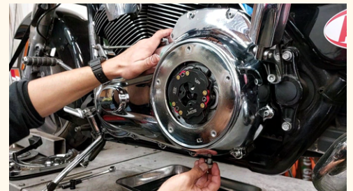
26. Return drain bolt.
